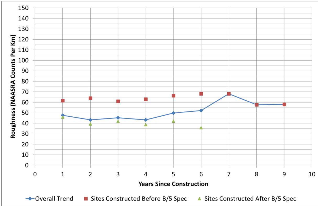
FIGURE 1: MEAN ROUGHNESS BY YEARS SINCE CONSTRUCTION
